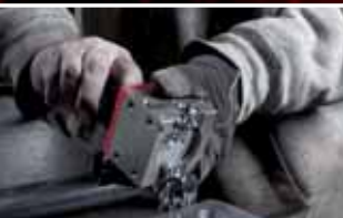
A l'arrêt du Magswitch tous les débris et copeaux tombent
